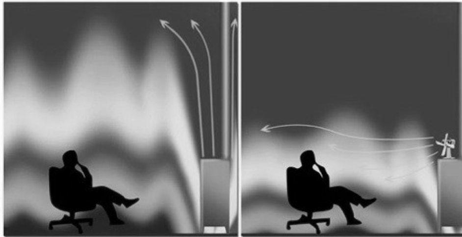
Distribuce tepla bez křbového ventilátoru
