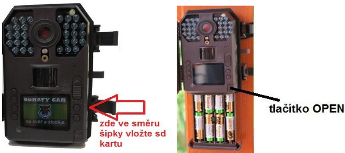
3. Pokud máte vložené baterie ve správné polaritě, zasunutý bateriový box a vloženou SD kartu, přepněte přepínač viz. obrázek z polohy OFF do polohy TEST!
